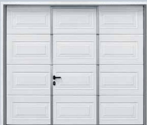
Les portillons incorporés s'ouvrent vers l'extérieur et sont placés au centre de la porte. Sur les portes de plus de 3500 mm de large (cassettes M de plus de 3000 mm), une configuration excentrée est également possible, voire nécessaire.
