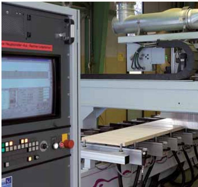
Une fraiseuse de précision pilotée par ordinateur réalise votre projet à façon dans les panneaux de bois de la porte.
